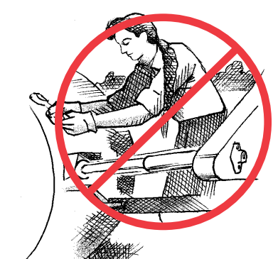
Atese el cabello largo cuando trabaja cerca del eje del PTO.
